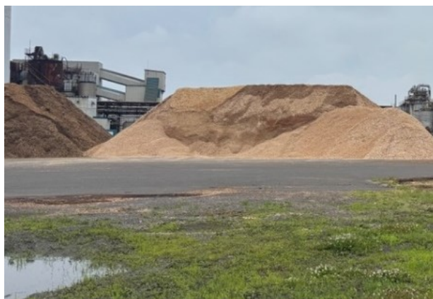
チップヤード（木質燃料の燃料チップを保管するスペース）
