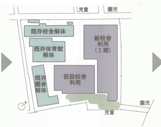
【STEP4：西側校舎解体】
