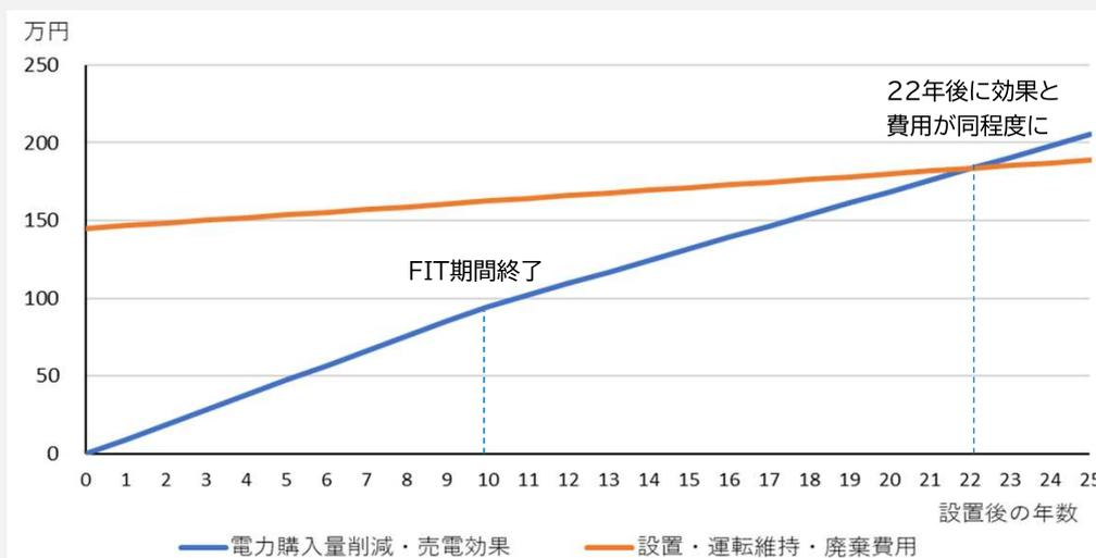
図1 太陽光発電システム5kWを設置した場合の経済性シミュレーション
